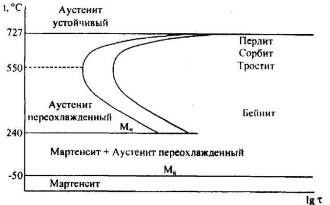
Рис 20. Диаграмма изотермического превращения аустенита эвтектоидной стали
